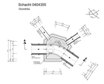
Erneuerung der innerstädtischen Mischwasserkanalisation DN 1100 – DN 400 in Tiefen bis 4,50 m auf einer Länge von ca. 800,00 m.
