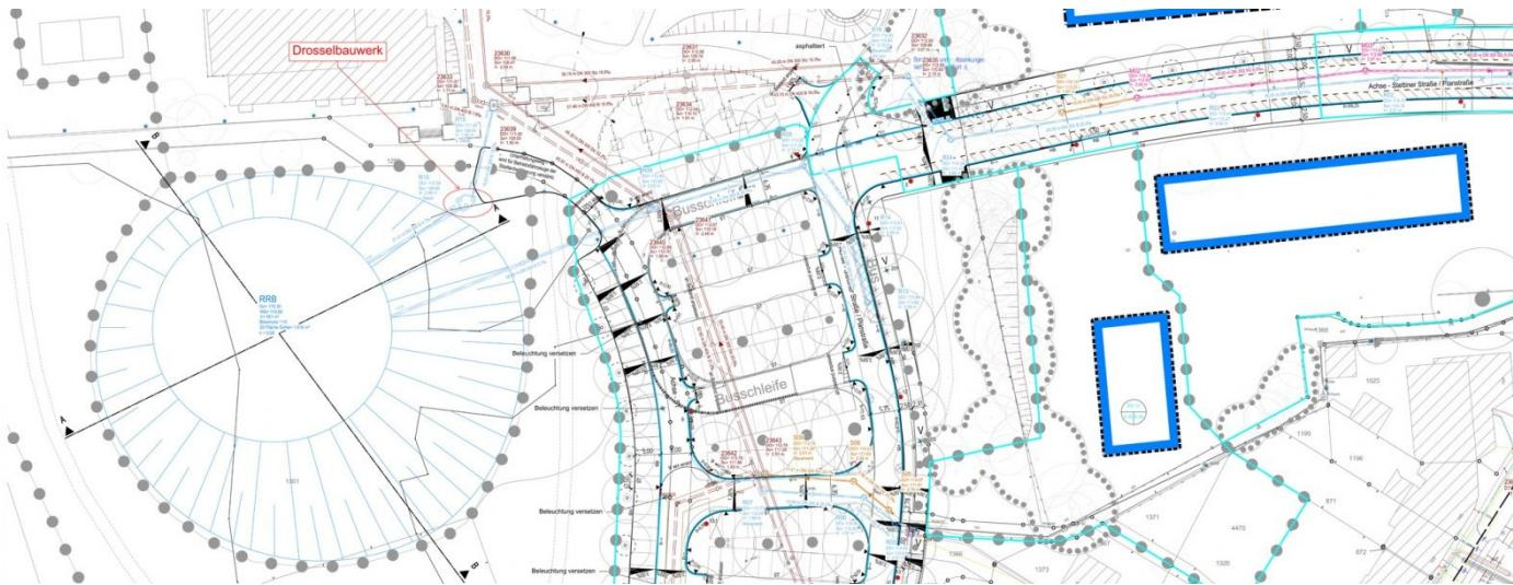
Zur Erschließung des B-Plans HÖ 273 in Dortmund Hörde wurde eine Trennkanalisation geplant. Es ist vorgesehen, das Schmutzwasser in das bestehende MW Netz einzuleiten.
