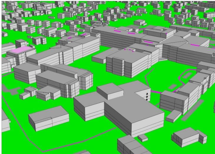
Für die geplanten Patientenzimmer war der Beurteilungspegel durch die einwirkenden Schallquellen (einschließlich der Schallquellen des WKK) zur Tag- und Nachtzeit gemäß der TA Lärm zu ermitteln.
