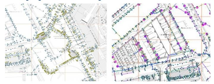
Die Flughafen Hamburg GmbH (FHG) führt seit 2010 umfangreiche Maßnahmen zur Bestandserfassung des betriebseigenen Netzes der Oberflächenentwässerung durch. Hierfür wurden und werden umfangreiche Bestandsvermessungen durchgeführt. Auf Grundlage dieser Vermessungsdaten erfolgte durch M+O zunächst die Aufstellung einer Kanaldatenbank. Die Anlagen der Oberflächenentwässerung werden als digitale Datensätze erfasst und in einer Datenbank verwaltet.
