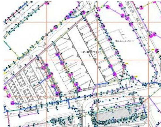
Die Flughafen Hamburg GmbH (FHG) führt seit 2010 umfangreiche Maßnahmen zur Bestands erfassung des betriebseigenen Netzes der Oberflächenentwässerung durch. Hierfür wurden und werden umfangreiche Bestandsvermessungen durchgeführt. Auf Grundlage dieser Vermessungsdaten erfolgte durch M+O zunächst die Aufstellung einer Kanal datenbank. Die Anlagen der Oberflächenentwässerung werden als digitale Datensätze erfasst und in einer Datenbank verwaltet.
