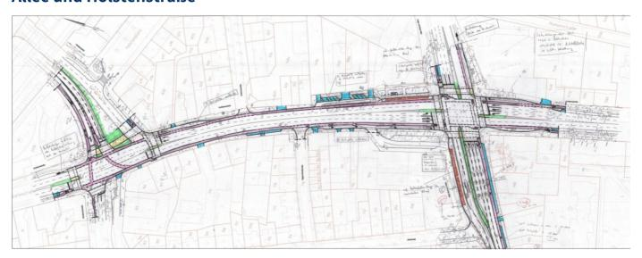
Die Max-Brauer-Allee in Hamburg-Altona ist eine Hauptverkehrsstraße mit starkem Bus- und Individualverkehr. Vom recht engen 4-streifigen Straßenquerschnitt werden tageszeitweise Bussonderfahrstreifen abgetrennt, um die vom und zum Bahnhof Altona verkehrenden Busse zu beschleunigen. Prägend für die Max-Brauer-Allee ist der historische Baumbestand auf dem breiten Mittelstreifen.
