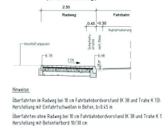
Ausbauquerschnitt III - III (Teilsanierung)
