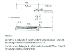
Ausbauquerschnitt III - III (Teilsanierung)
