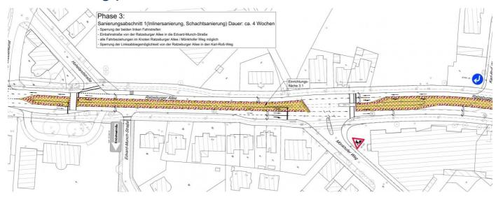
In der Ratzeburger Allee in Lübeck wurde festgestellt, dass große Teile des Mischwasserkanals (Eiprofil DN 1138/1700) defekt bzw. abgängig sind. Aufgrund der Schwere der Schäden bestand kurzfristiger Handlungsbedarf.
